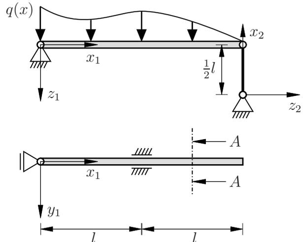
Bestimmen Sie alle kinematischen Randbedingungen, die zum eindeutigen Aufstellen der Biegelinien  $w(x_1)$ ,  $v(x_1)$  sowie der Längenänderung des Stabes  $u(x_2)$  nötig sind. **(3,0 Punkte)**
