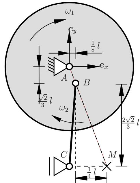
Zeichnen Sie **in das nachfolgende Kästchen** die Richtung des Geschwindigkeitsvektors des Punktes  $B$  ein. Kennzeichnen Sie dabei auftretende rechte Winkel eindeutig und nehmen Sie an, dass sich die Kreisscheibe in Richtung des Uhrzeigersinnes dreht. **(1,0 Punkte)**
