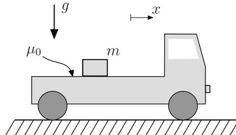
Bestimmen Sie die maximale Beschleunigung  $a_0^{\max}$ , mit welcher der Lastwagen zum Zeitpunkt  $t = t_0$  beschleunigen darf, sodass die Masse  $m$  nicht von der Ladefläche rutscht.
