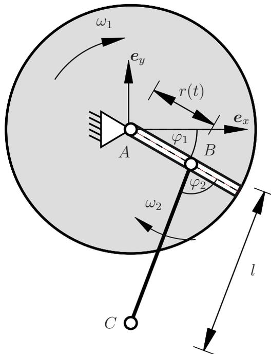
Bestimmen Sie die Komponenten des Geschwindigkeitsvektors  $\mathbf{v}_C = v_{C_x} \mathbf{e}_x + v_{C_y} \mathbf{e}_y$  des Punktes  $C$  im gegebenen, globalen  $e_x, e_y$ -Koordinatensystem. **(5,0 Punkte)**
