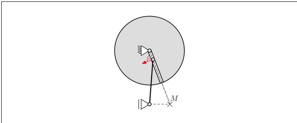
Bestimmen Sie nun die Winkelgeschwindigkeit  $\omega_1$  der Kreisscheibe in Abhängigkeit der Winkelgeschwindigkeit  $\omega_2$  des Stabes für die dargestellte Lage. **(2,0 Punkte)**
