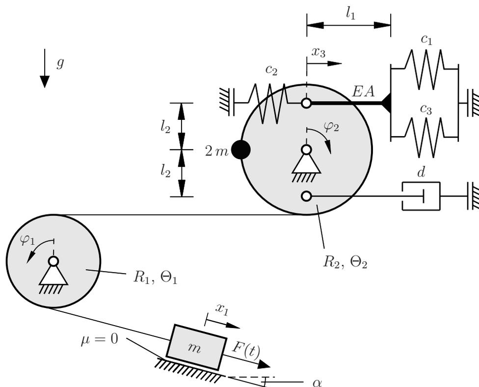
Bestimmen Sie die Ersatzfedersteifigkeit für den Mechanismus an der rechten Rolle  $R_2$ , bestehend aus den Federn  $c_1, c_2, c_3$  und dem Dehnstab. **(1,5 Punkte)**
