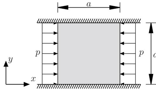
1.11 Wie groß darf der Druck  $p$  maximal sein, damit, unter der Annahme der Spannungshypothese nach Tresca, kein Versagen auftritt?
