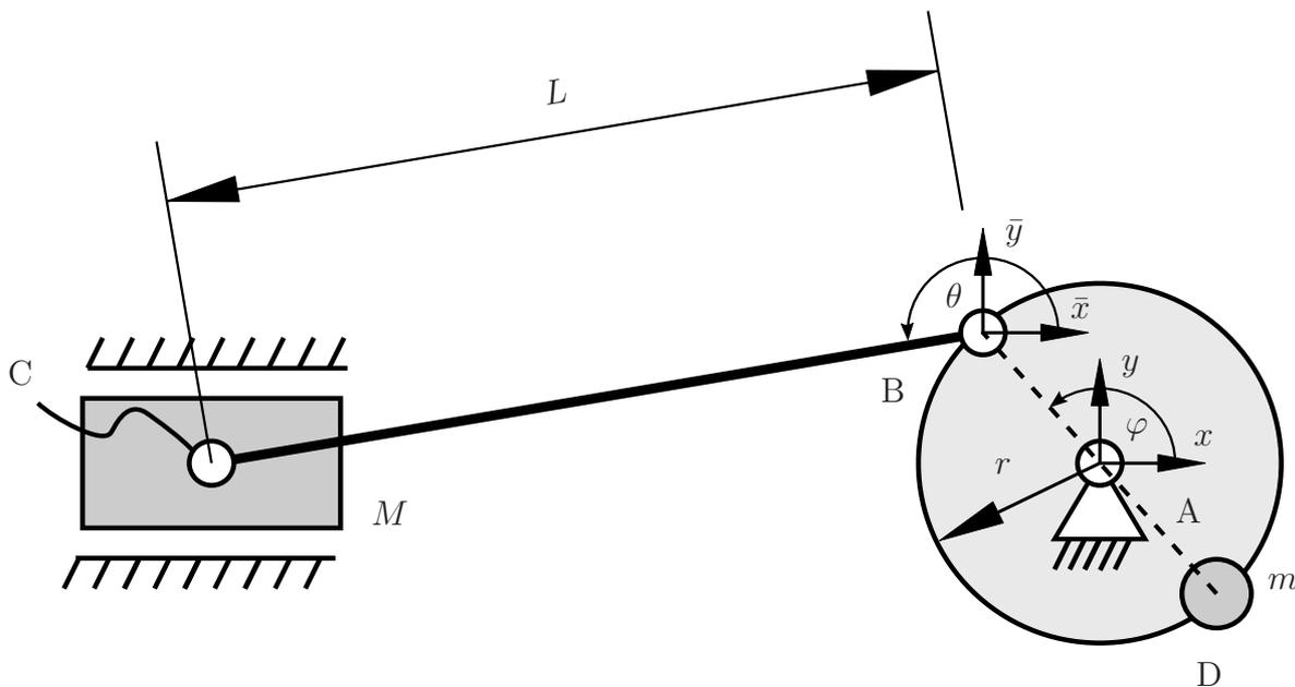
**3.1** Bestimmen Sie für die dargestellte Lage den horizontalen Anteil  $\ddot{x}_B$  der Absolutbeschleunigung des Punktes B in Abhängigkeit der gegebenen Größen sowie der Winkelgeschwindigkeit  $\dot{\varphi}$  und Winkelbeschleunigung  $\ddot{\varphi}$ . (1,5 Punkte)
