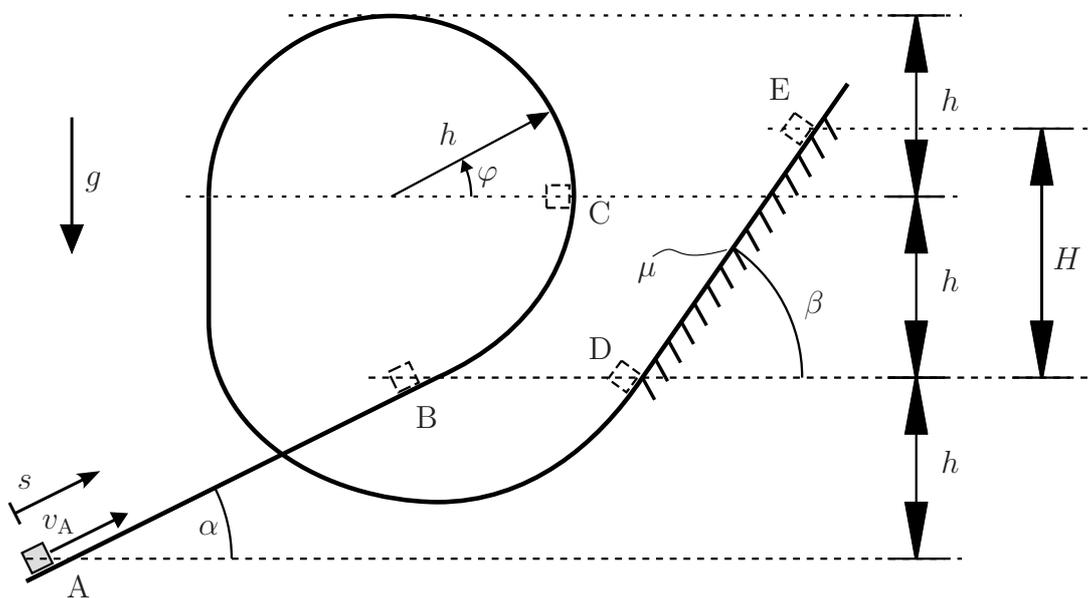
**2.1** Bestimmen Sie die Beschleunigung  $\ddot{s}$  der Masse zwischen den Punkten A und B. (1,0 Punkte)
