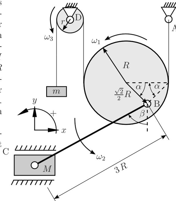
3.4 Welche der folgenden Abbildungen zeigt die korrekte Konstruktion des Momentanpols des Stabes? (1,0 Punkte)
