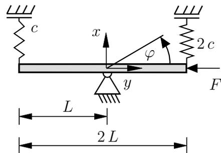
Das Potential der Federn im System ist mit  $\Pi_f(\varphi) = \frac{3}{2}c(L\sin(\varphi))^2$  gegeben.
