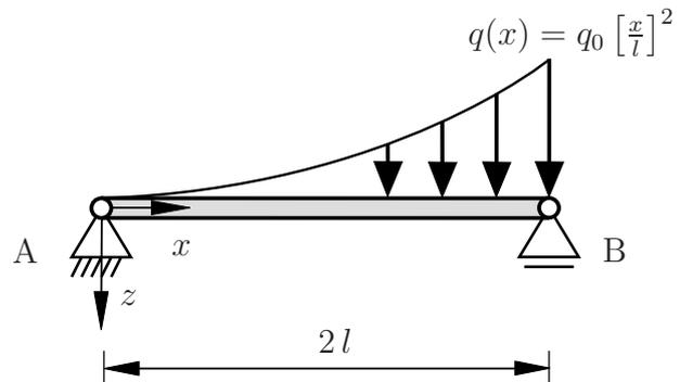
Berechnen Sie, an welcher Stelle  $x$  des Balkens das maximale Biegemoment  $M(x)$  auftritt. Der Angriffspunkt der resultierenden Streckenlast ist bereits als  $x_R = 3l/2$  gegeben. Verwenden Sie das vorgegebene lokale Koordinatensystem. Es ist darauf zu achten, dass der Lösungsweg schlüssig und vollständig dargestellt wird. **(3,0 Punkte)**
