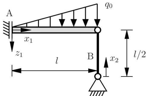
Die in positive  $x_1$ - $z_1$ -Koordinatenrichtung angenommenen Lagerreaktionen in Punkt A wurden bereits zu  $A_{x_1} = 0$  und  $M_A = -\frac{1}{6} q_0 l^2$  bestimmt. Die Druckkraft der Pendelstütze B ist  $B = \frac{1}{2} q_0 l$ . Bestimmen Sie den Biegemomentenverlauf  $M(x_1)$  des Balkens bezüglich des vorgegebenen lokalen Koordinatensystems. **(1,5 Punkte)**
