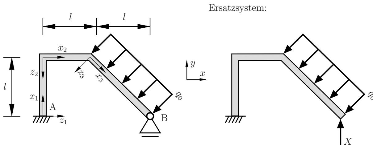
Für  $X = 0$  ergeben sich die Lagerreaktionen im statisch bestimmten Ersatzsystem in Punkt A bezüglich der positiv definierten Koordinatenrichtungen des  $x$ - $y$ -Koordinatensystems zu
