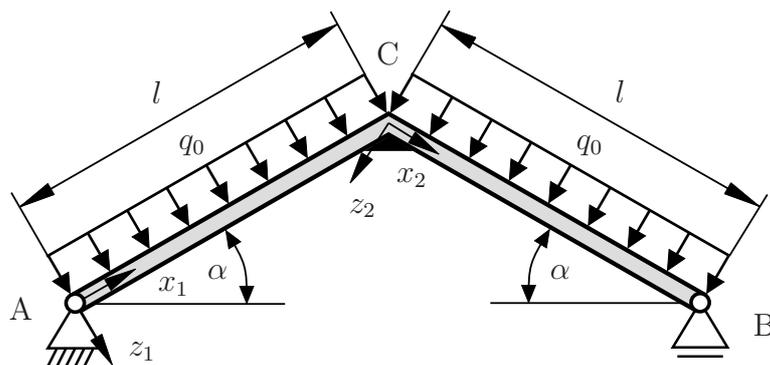
Geben Sie alle **kinematischen** Rand- und Übergangsbedingungen an, die zur Bestimmung der Biegelinien  $w_i(x_i)$  erforderlich sind. **(2,0 Punkte)**
