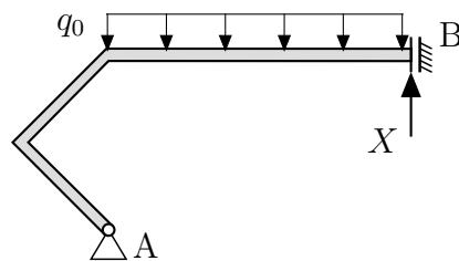
Zeichnen Sie die Biegemomentenverläufe  $M_q(X = 0)$  und  $M_X(q_0 = 0)$  des statisch bestimmten Ersatzsystems. Geben Sie charakteristische Werte und die jeweiligen Polynomgrade  $p$  der Funktionen mit an.
