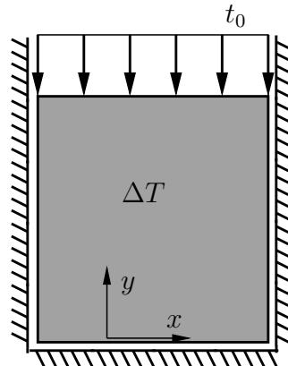
Berechnen Sie alle dreidimensionalen Spannungs- und Dehnungskomponenten in der Scheibe. **(3,5 Punkte)**
