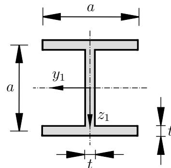
Unter der Annahme  $t \ll a$  gelten für die Querschnittsfläche  $A$  und das Flächenträgheitsmoment  $I_{yy}$  des Profils
