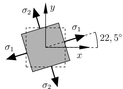
Lesen Sie die Hauptspannungen  $\sigma_1$  und  $\sigma_2$  sowie die maximale Schubspannung  $\tau_{\max}$  ab. **(1,0 Punkte)**
