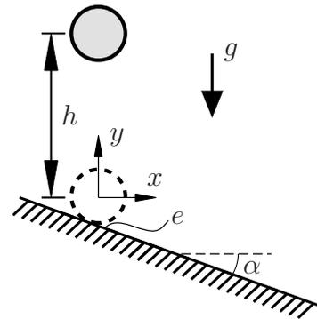
Bestimmen Sie die Geschwindigkeit  $\bar{\mathbf{v}} = \bar{v}_x \mathbf{e}_x + \bar{v}_y \mathbf{e}_y$  der Scheibe unmittelbar nach dem Stoß in Abhängigkeit des gegebenen  $x$ - $y$ -Koordinatensystems. **(2,0 Punkte)**
