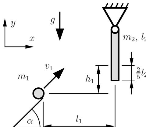
Bestimmen Sie die Zeitspanne  $t^*$  bis zum Aufprall und die Höhe  $h_1$ , in der die Masse auf den Stab trifft. **(1,0 Punkte)**
