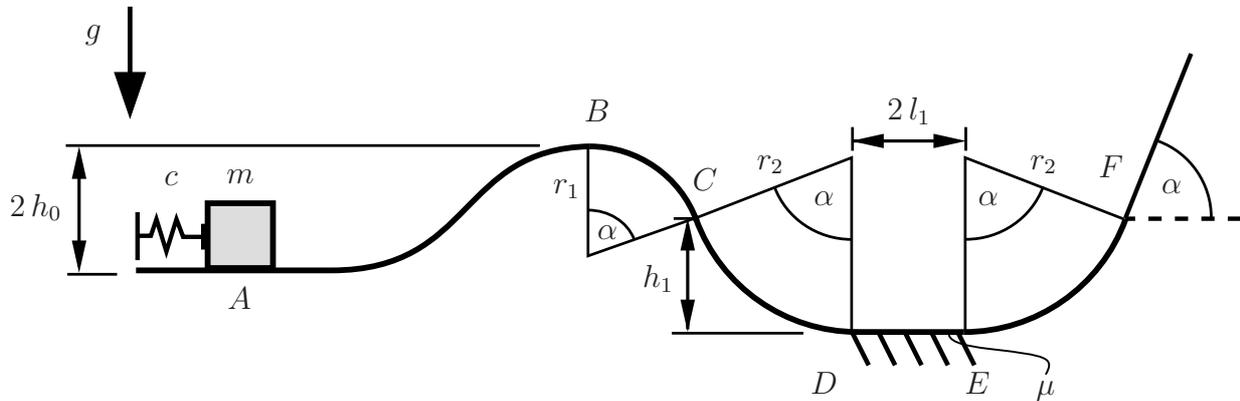
Eine Punktmasse  $m$  liegt in Punkt  $A$  an einer vorgespannten Feder (Federsteifigkeit  $c$ ). Die Bahn beschreibt zwischen den Punkten  $B$  und  $C$ ,  $C$  und  $D$  und  $E$  und  $F$  jeweils eine Kreisbahn. Zwischen den Punkten  $D$  und  $E$  gilt der Gleitreibungskoeffizient  $\mu$ , die Bahn ist ansonsten reibfrei. Das System befindet sich im Schwerfeld der Erde. Die Punktmasse hat durchgehend Kontakt mit der Bahn.
