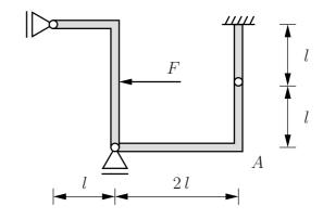
Zeichnen Sie eine ausgelenkte Lage inklusive des Moments  $M_{\rm A}$  und des dazu korrespondierenden Freiheitsgrads ein. Geben Sie sämtliche Winkel in Abhängigkeit dieses Freiheitsgrades an. (1,0 Punkte)
