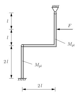
In der nachfolgenden Skizze ist bereits eine Fließgelenk-Konfiguration für kleine Auslenkungen und deren Winkeln eingezeichnet. Tragen Sie die plastischen Momente ein und berechnen Sie die Tragkraft  $F_{\rm T}$  für kleine Auslenkungen. (1,0 Punkte)
