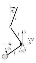
Stellen Sie für beliebig große Auslenkungen das Gesamtpotential  $\Pi$  des Systems in Abhängigkeit der Freiheitsgrade  $q_1$  und  $q_2$  auf. Beachten Sie das vorgegebene Nullniveau NN und fassen Sie die einzelnen Terme **nicht** zusammen. (3,0 **Punkte**)
