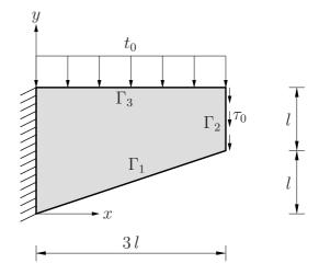
$\Gamma_1$ : Normalenvektor:  $[\boldsymbol{n}_1] = \frac{1}{\sqrt{10}} \begin{bmatrix} 1 \\ -3 \end{bmatrix}$ ; Spannungsvektor:  $\boldsymbol{t}_1 = \boldsymbol{\sigma} \cdot \boldsymbol{n}_1$ Randbedingung für spannungsfreien Rand:
