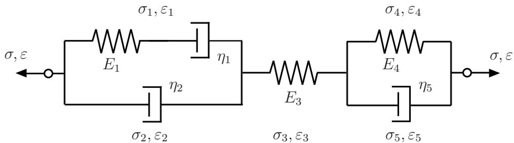
Bestimmen Sie die grundlegenden konstitutiven Gleichungen der Teilkörper 1, 2, 3, 4, 5 und alle wichtigen Beziehungen des Gesamtsystems, die zur Herleitung des Stoffgesetzes des Gesamtsystems benötigt werden, **ohne** diese ineinander einzusetzen oder zu lösen. **(3,0 Punkte)**
