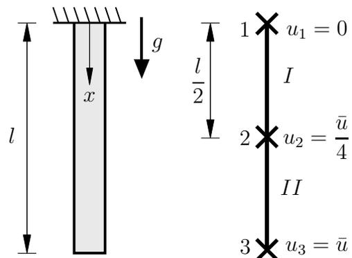
Geben Sie die Koordinatentransformation  $x_{II}^h(\xi)$  von Element *II* auf das Masterelement für das oben abgebildete System an. Geben Sie zudem die inverse Funktion  $\xi_{II}^h(x)$  für das gleiche Element an. **(1,0 Punkte)**
