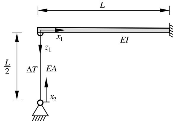
3.1 Welche der nachfolgenden Aussagen trifft auf die geometrischen Rand-/Übergangsbedingungen der Axialverschiebung  $u(x_2 = 0)$  in der Pendelstütze zu? **(0,5 Punkte)**
