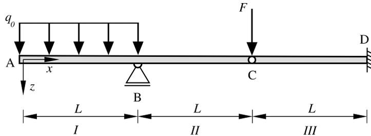
Für die drei Bereiche wurden die Verläufe der Biegelinie bestimmt. Diese lauten in Abhängigkeit der noch unbekanntenen Konstanten  $a_1, a_2, b_1, b_2, c_1$  und  $c_2$ :
