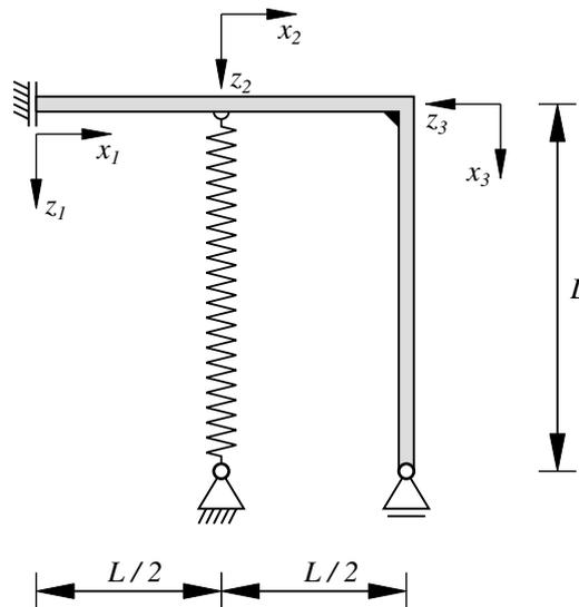
**3.4** Welche der nachfolgenden geometrischen Rand-/Übergangsbedingungen an die Funktion der Biegelinie  $w$  an der Stelle  $x_1 = 0$  sind vollständig und korrekt? (0,5 Punkte)
