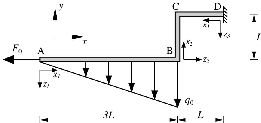
Bestimmen Sie für das dargestellte System die Komponenten der Auflagerreaktion in Punkt D bezüglich der durch das globale  $x$ - $y$ -Koordinatensystem als positiv definierten Richtungen.
