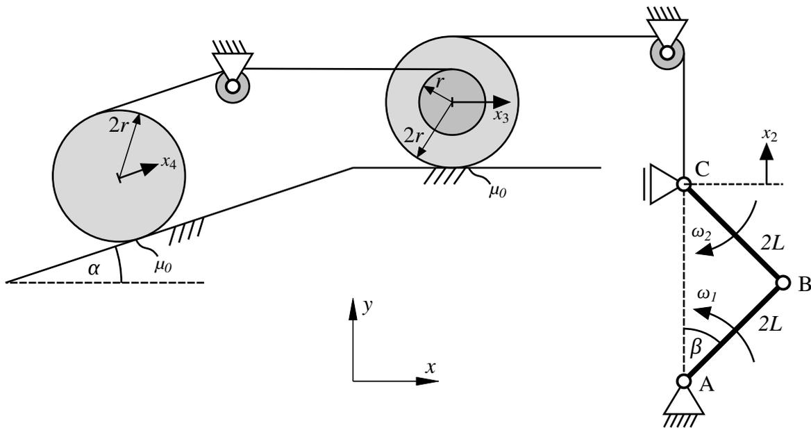
Es sollen nun für die dargestellte Lage des Systems ( $\beta = 45^\circ$ ) in Abhängigkeit einer gegebenen Winkelgeschwindigkeit  $\omega_1$  die Geschwindigkeitsvektoren  $\mathbf{v}_B$  und  $\mathbf{v}_C$  (bezogen auf das globale  $x$ - $y$ -System) bestimmt werden.
